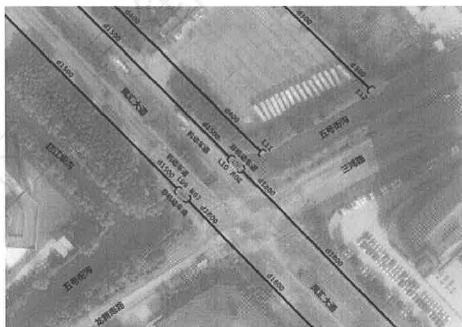
图3-5 凤汇大道与五号街沟交叉处雨水管道现状
