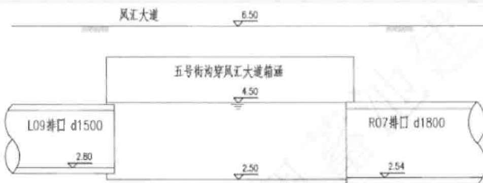
图3-7 L09、R07 排口与五号街沟标高关系示意图
