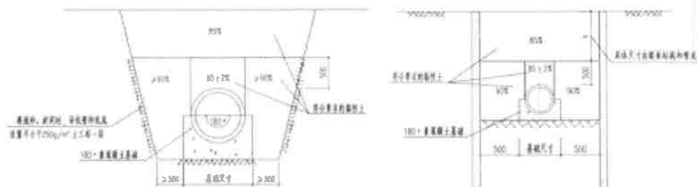
图 2-10 绿化带下钢筋混凝土管沟槽回填图
