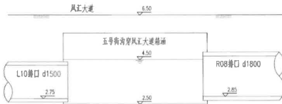
图3-6 L10、R08 排口与五号街沟标高关系示意图
