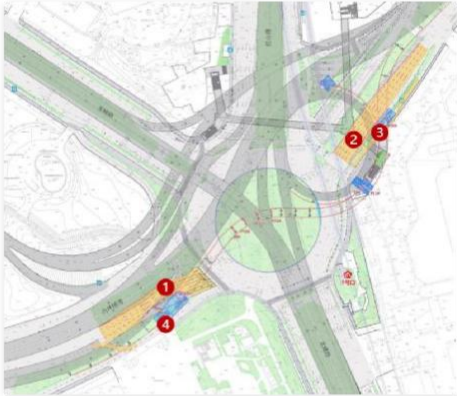
图 2-12 下部第二阶段保通方案示意图
