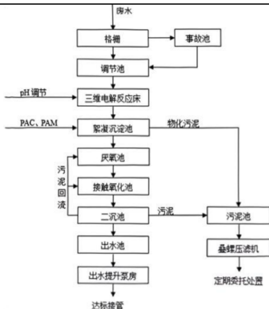
图 4-2 园区废水预处理装置处理工艺流程图
