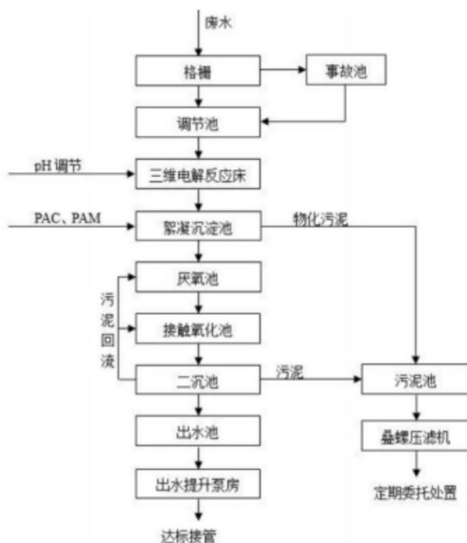
图 4-3 园区污水处理站工艺流程
