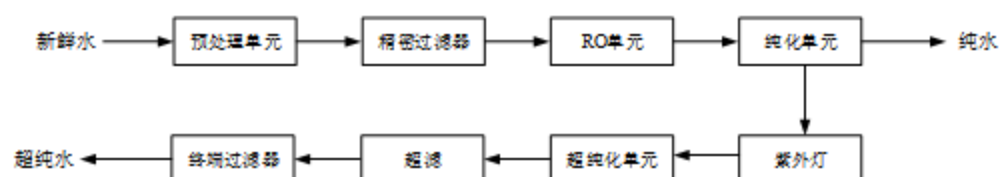
图 2-1 项目纯水、超纯水系统制备工艺流程
