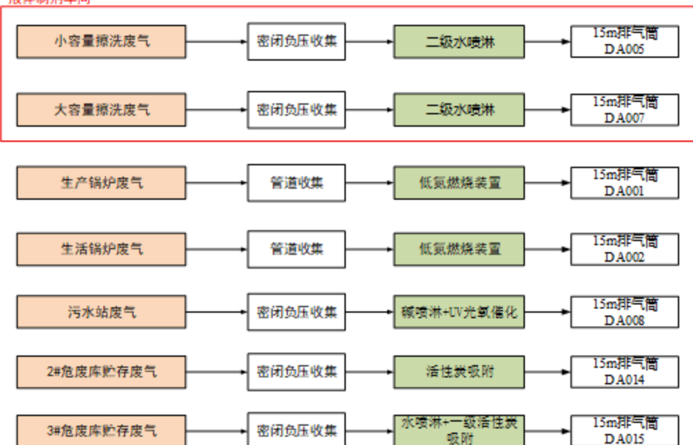
图 4-1 改扩建项目废气处理工艺图
