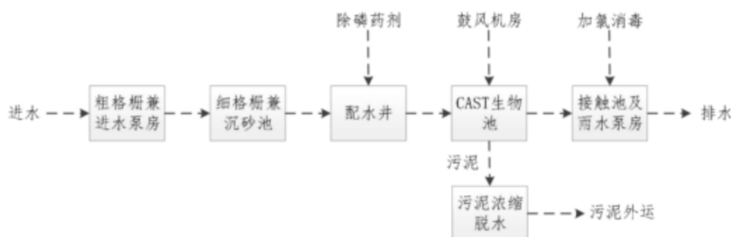
图 4-5 仙林污水处理厂处理工艺流程示意图
