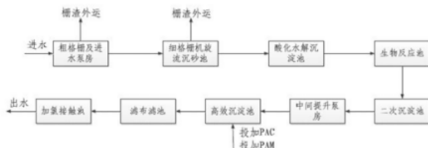
图 4-2 浦口经济开发区污水处理厂污水处理工艺流程图
