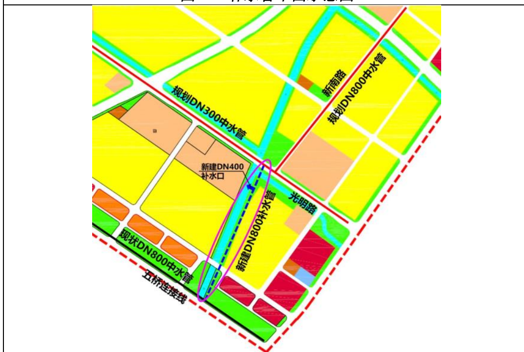
图 2-8 新建 DN800 补水管及 DN400 补水口平面示意图
