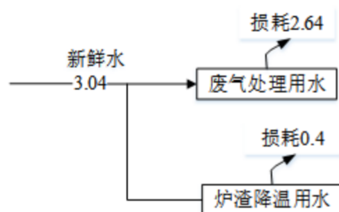
图 2-1 改建项目水平衡图 单位 (m³/a)
