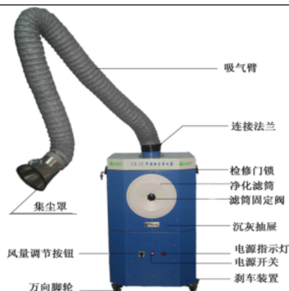
图 4-2 移动式除尘器结构简图
