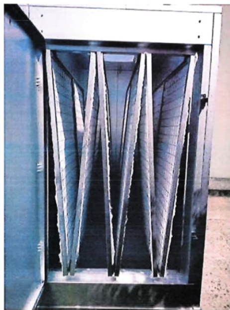
图4-2 干式过滤棉结构示意图
