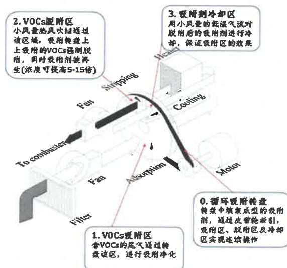
图 4-2 转轮吸附工作原理图
