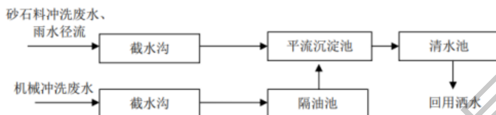
图 5-1 施工废水处理工艺图
