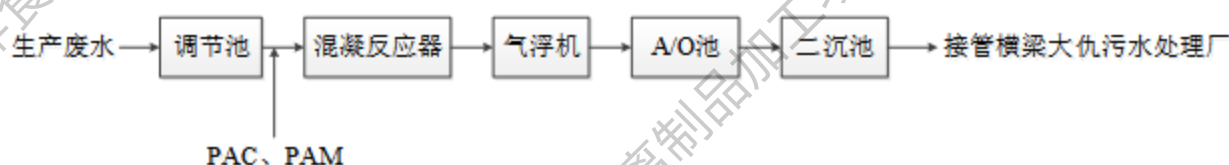
图 4-3 废水处理系统工艺流程图
