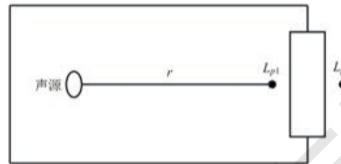
图4-6室内声源向室外传播示意图
