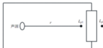
图4-3室内声源向室外传播示意图
