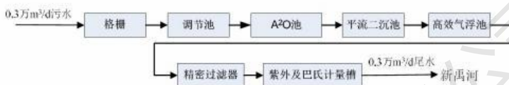
图 4-2 龙袍街道东沟污水处理厂工艺流程图
