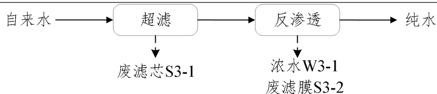
图 2-4 纯水机制备工艺
