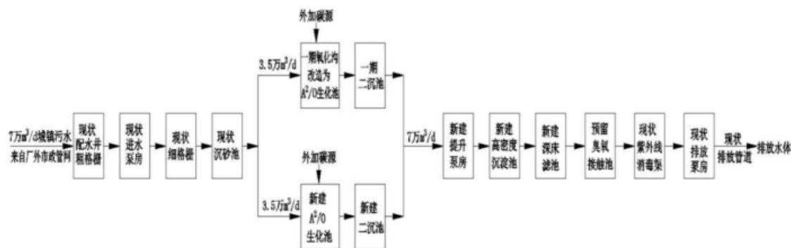
图 4-2 江宁区滨江污水处理厂工艺流程图
