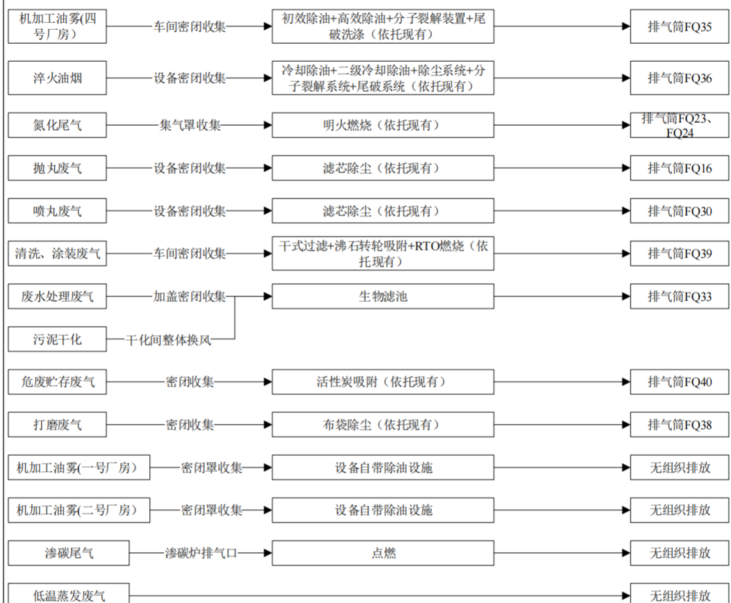
图4-1本项目废气处理措施示意图
