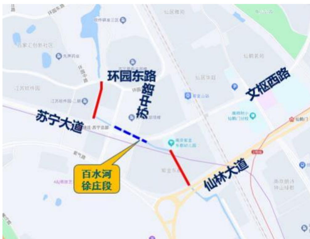
图 2.3-5 百水河徐庄段疏浚段落平面示意图（红线明渠疏浚、蓝线暗涵疏浚）
