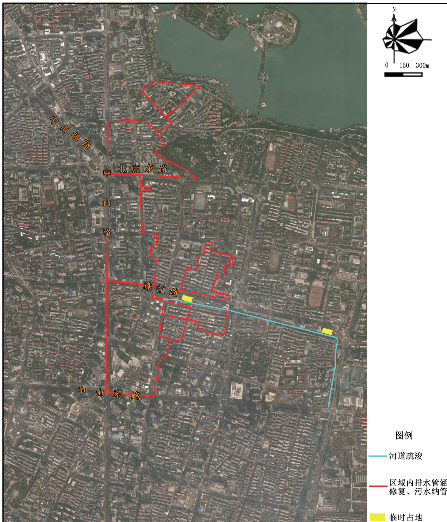
附图2-1 工程1施工总布置图
