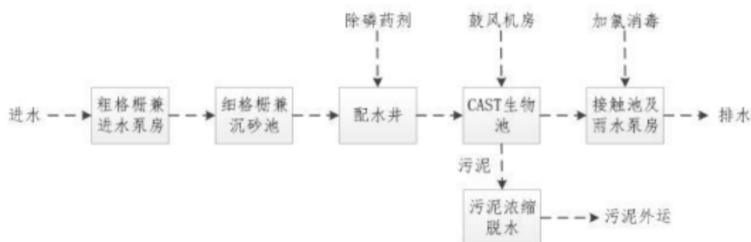
图 4-3 仙林污水处理厂污水处理工艺流程图
