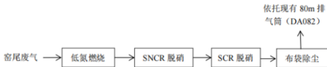
图 5-1 本项目有组织废气收集及处理措施（依托现有）
