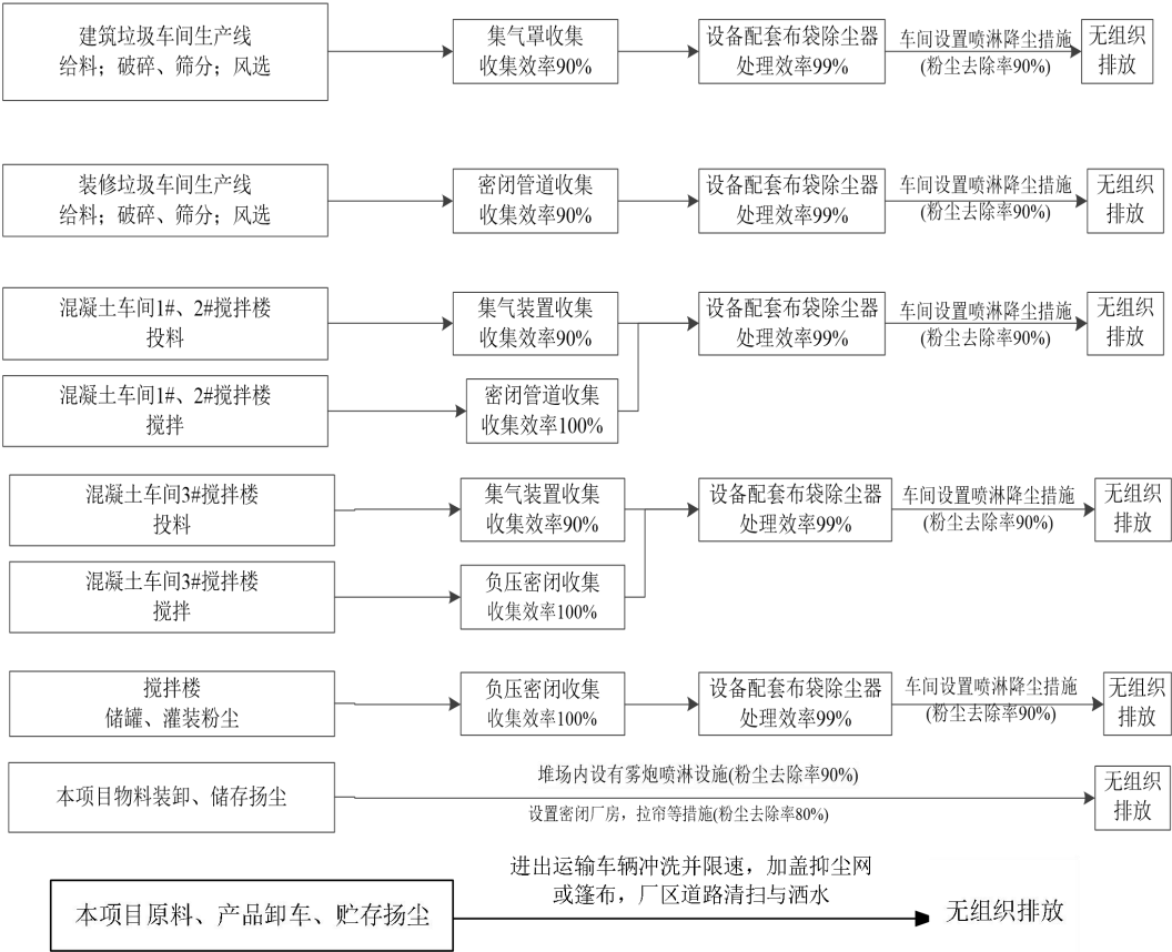
图4-1 本项目废气处理工艺流程
