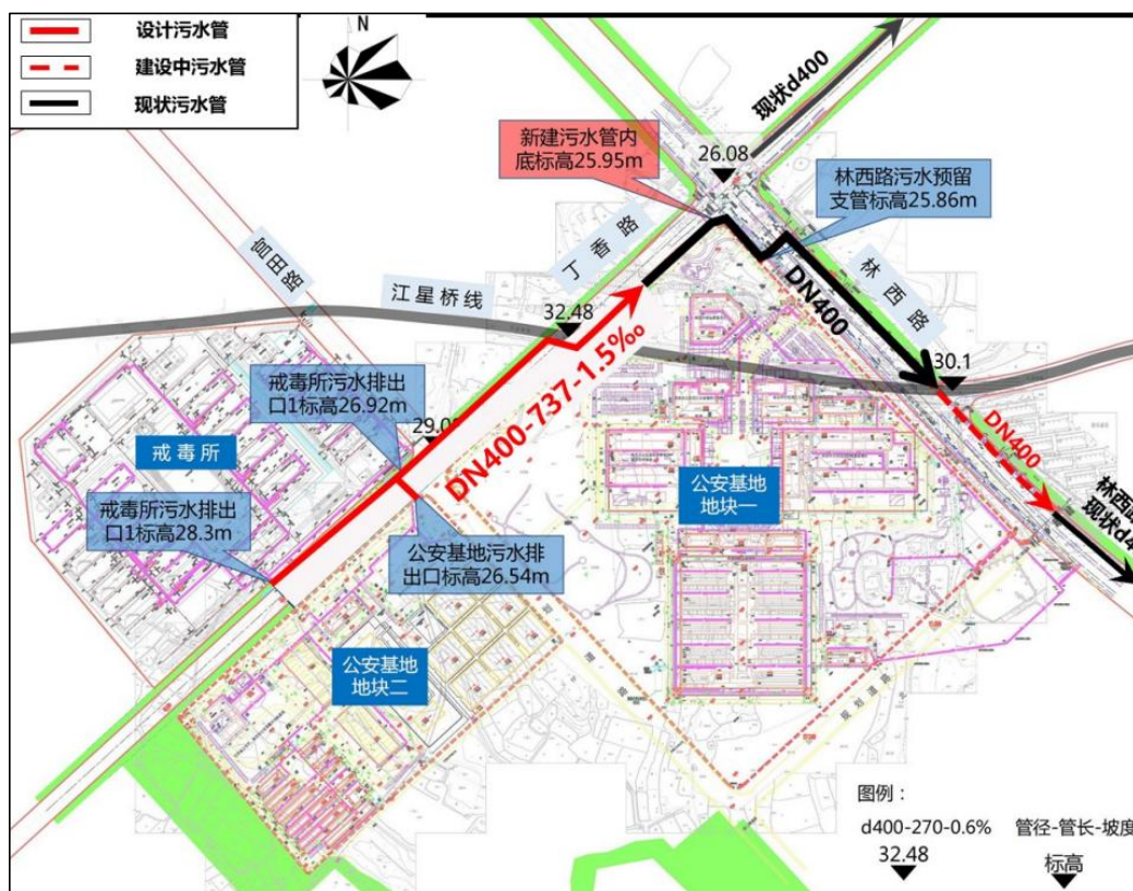
图 2-13 生活污水管平面布置图
