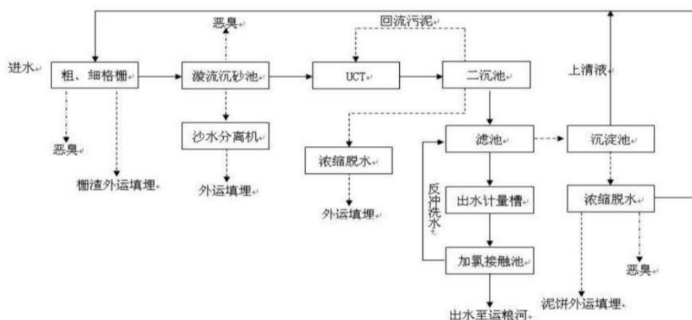
图 4-1 城东污水处理厂污水处理工艺流程图
