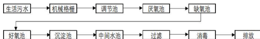
图 4-2 高淳区桤溪污水处理厂工艺流程图
