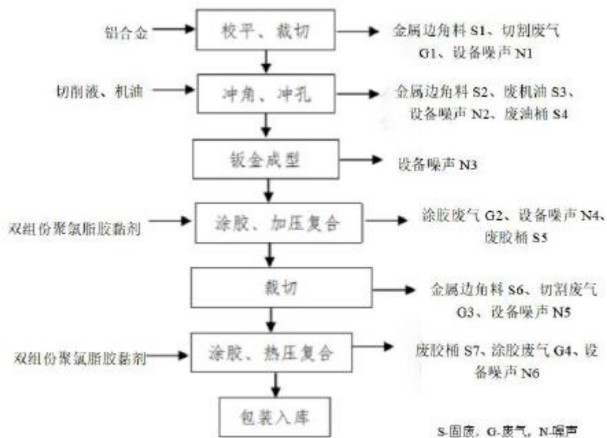
图 2-4 铝板幕墙生产工艺流程图
